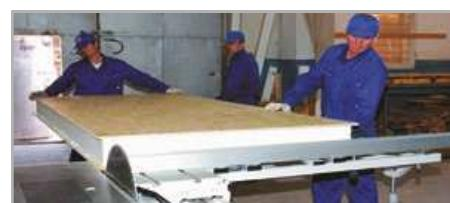
**III.** В цеху по производству и изготовлению конструкционных элементов зданий происходит доведение «голого» сэндвича до изделия повышенной готовности к отправке или к монтажу на стройплощадке. Площадь, занимаемая этим производством, составляет около 216 м<sup>2</sup> (в плане 12 x 18 м, высота – от 4 м и более).
