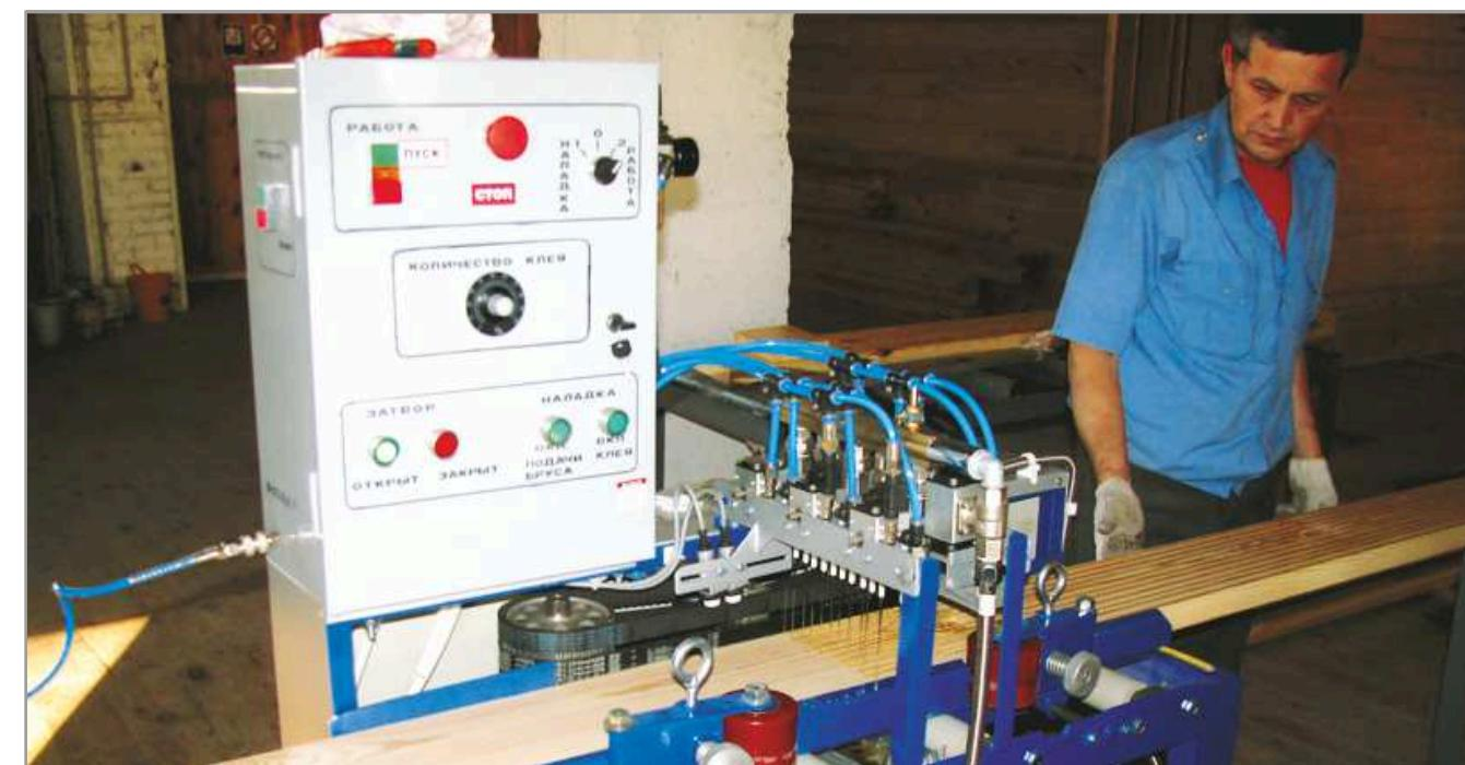
Машина kleenanoсящая предназначена для строго дозированного нанесения однокомпонентного полиуретанового клея на заготовки шириной от 50 до 300 мм и высотой от 20 до 150 мм со скоростью до 1000 м пог./час.
