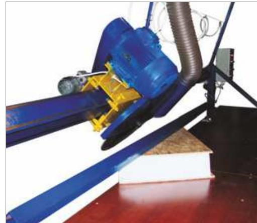
Основная направляющая балка имеет сложную сварную конструкцию. Собирается на специальном стапеле, после чего проходит испытания на кручение и изгиб. По окончанию испытаний и проверки геометрических параметров ей присваивается заводской номер и ставится соответствующее клеймо. Прижимная балка на столе имеет пневматический привод с нижним расположением цилиндров, что позволяет прочно удерживать панель максимально близко к пильному диску.
