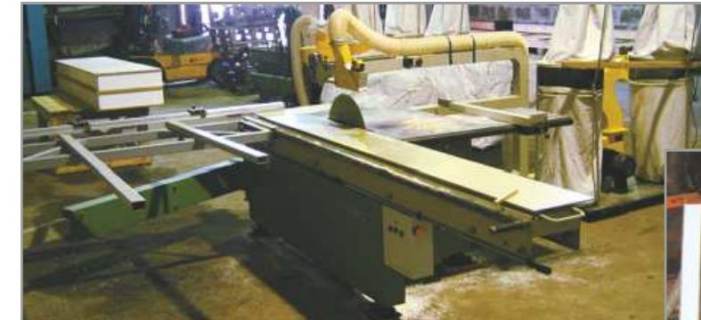
Подвижная каретка станка перемещается по высокоточным направляющим со специальной вогнутой фрезеровкой.
