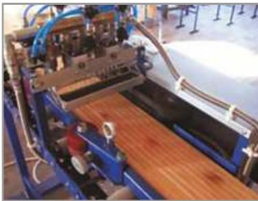
Подача клея контролируется электронным расходомером в режиме реального времени и имеет плавную регулировку от 0 до 250 г/м2. Kleenanoсящий узел комплектуется клапанами итальянской фирмы «Самоззи» и оборудован затвором с запорной жидкостью. Автоматическое закрытие затвора происходит при отключении электропитания, снижения давления воздуха, либо паузе в работе машины более 3-х минут, ручное закрытие при нажатии соответствующей клавиши на панели управления.
